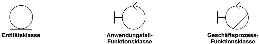
Abb. 24–1 Symbole der drei Klassen-Stereotype der Softwarespezifikation
