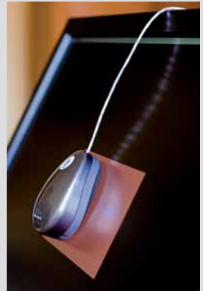
Abb. 2-11 Ein Messgerät (Eye-One Display 2) im Einsatz
