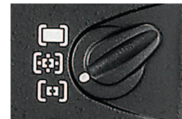
Abbildung 4: Wähler für die AF-Messfeldsteuerung auf Einzelfeldsteuerung
