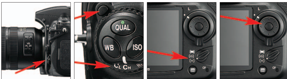
Abbildung 2: Fokusschalter, Aufnahmebetriebsartenwähler, Wähler für die AF-Messfeldsteuerung und Multifunktionswähler
