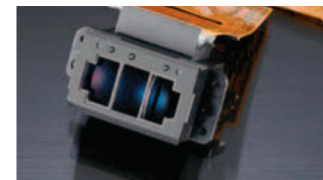
Abbildung 1: Das Autofokusmodul Multi-CAM 3500FX (Foto: Nikon)
