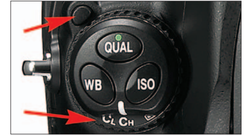
Abbildung 10: Aufnahmebetriebsartenwähler in der C H -Stellung; Entriegelung links oben
