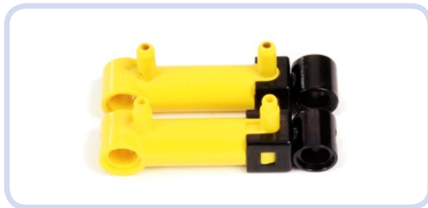
Abbildung 10-3: Ein kleiner Pneumatikzylinder aus dem neuen System (oben) und aus dem V2-System (unten). Größe, Fassungsvermögen und Leistung sind identisch, aber die V2-Version hat verstärkte Spitzen und gestufte Anschlüsse. Letztes erleichtert das Aufstecken der Schläuche.
