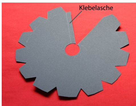
Abb. 1.4.1: Herstellung Lautsprechermembran, Schritt 1: Ausschneiden und Knickstellen einritzen
