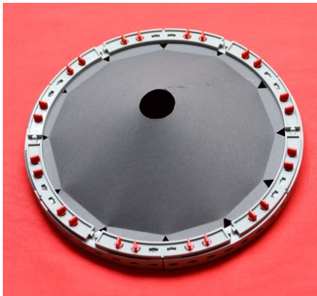
Abb. 1.4.3: Herstellung Lautsprechermembran, Schritt 3: Einbau in fischertechnik-60°-Bogenteile, Rückansicht
